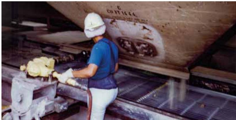
VIBRADOR PARA AGILIZAR A DESCARGA DE FARELOS E PELLETS DE SOJA E MILHO - BATTON ROUGE - LUISIÂNIA - EUA
