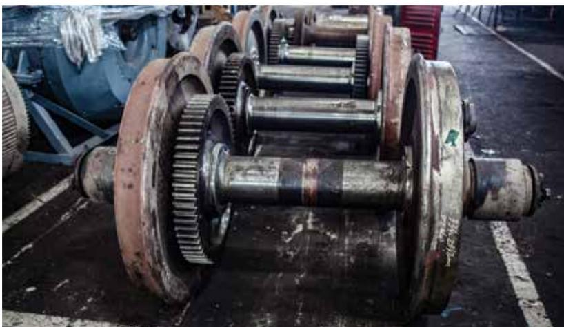
RODAS E EIXO MOTOR DA LOCOMOTIVA DIESEL-ELÉTRICA - FTC FERROVIA TEREZA CRISTINA
