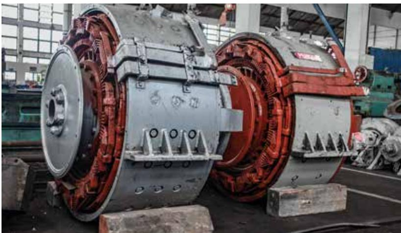
GERADORES ELÉTRICOS DA LOCOMOTIVA DIESEL-ELÉTRICA - FTC FERROVIA TEREZA CRISTINA
