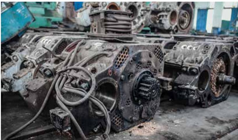
MOTORES ELÉTRICOS DE TRACÇÃO DA LOCOMOTIVA DIESEL-ELÉTRICA - FTC FERROVIA TEREZA CRISTINA
