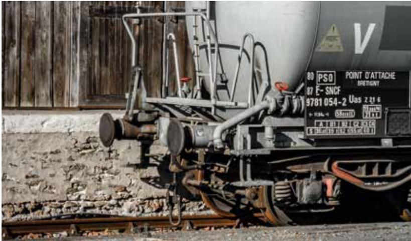
VAGÃO TANQUE - SNCF - ESTAÇÃO RAMBOUILLET - FRANÇA - ENGATE MANUAL TIPO EUROPEU
