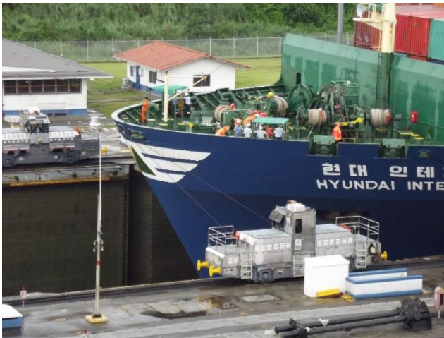
Locomotiva tracionando embarcação dentro da eclusa Miraflores. Canal do Panamá, Panamá. Foto de Samuel Sembalista Haurelhuk, 2013.
