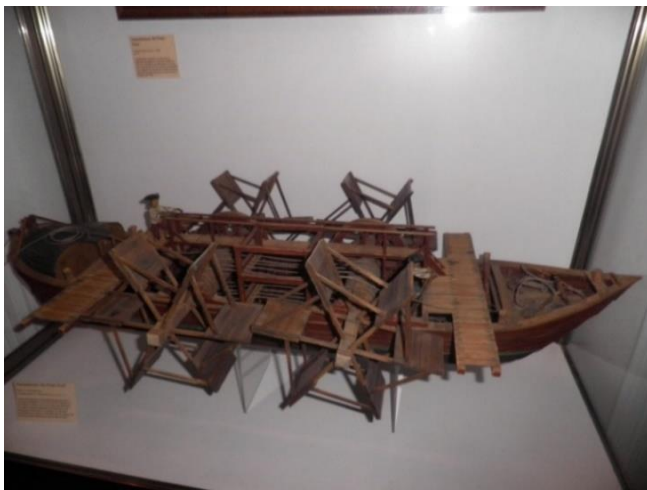
Aquamotor, nave com rodas de pás que tracionava o cabo preso em um ponto fixo. Maquete do Musée de la Batellerie, França.
