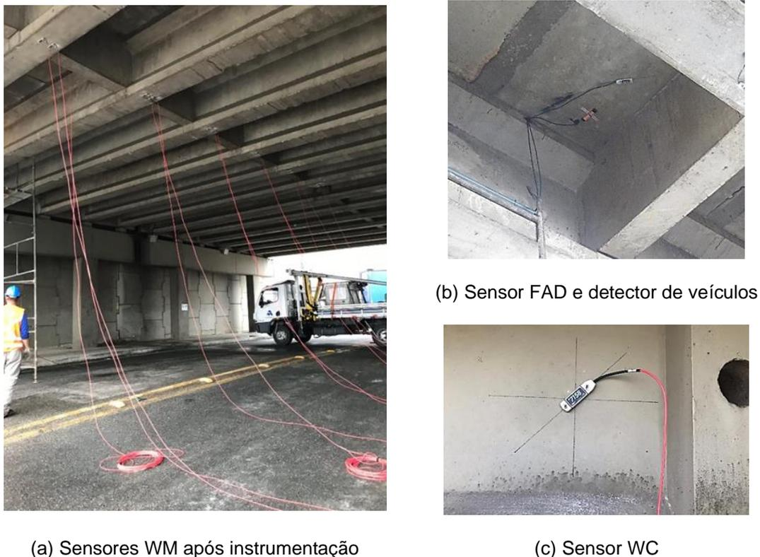
Figura 3 - OAE após a instrumentação dos sensores e equipamentos.
