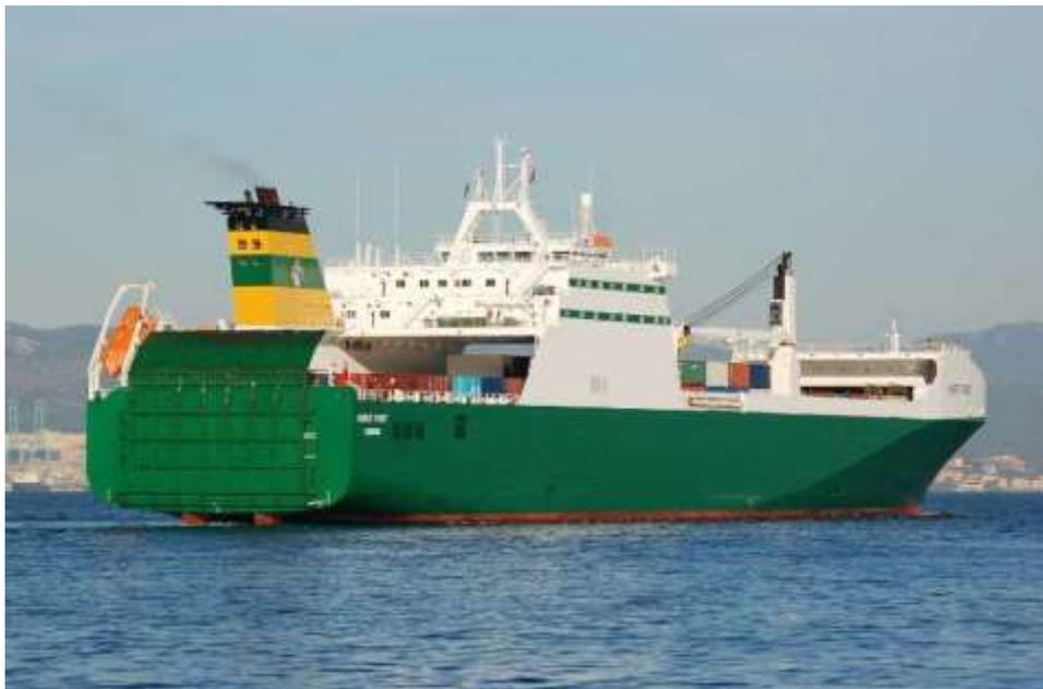
Figura 2.50. Navio de Operação por Rolamento (Ro-Ro)
