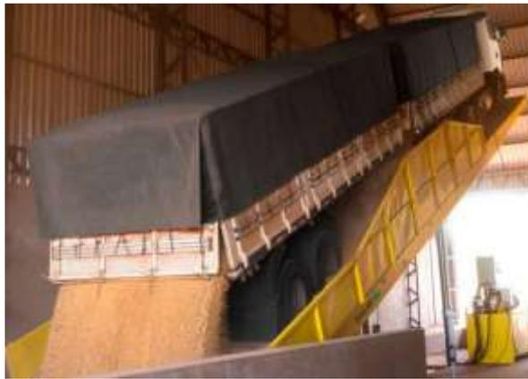
Figura 6.33. Tombador (plataforma de descarga)
