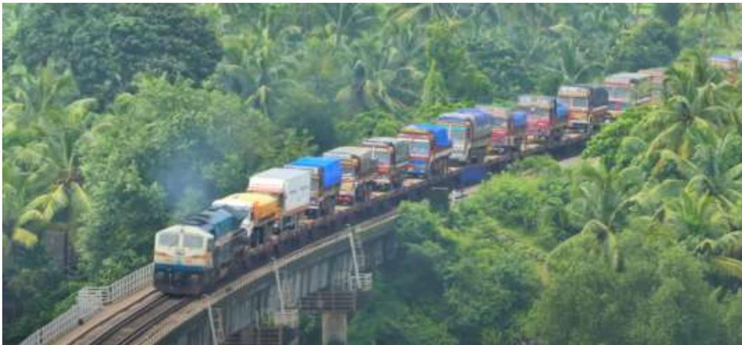
Figura 6.49. Caminhões carregados sendo transportados por vagão ferroviário
