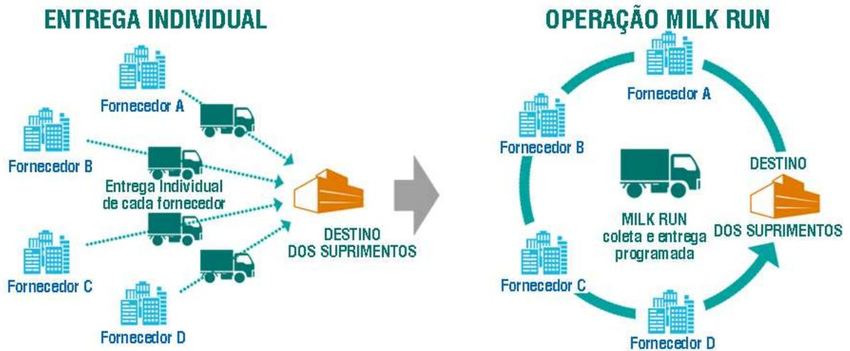
Figura 6.48. Comparativo entre entregas individuais e a Operação Milk Run
