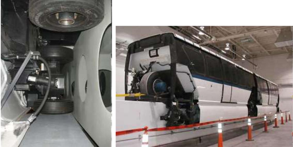
Figura 3.48. Rodas abraçadoras (esquerda) e pneus propulsores (direita)
