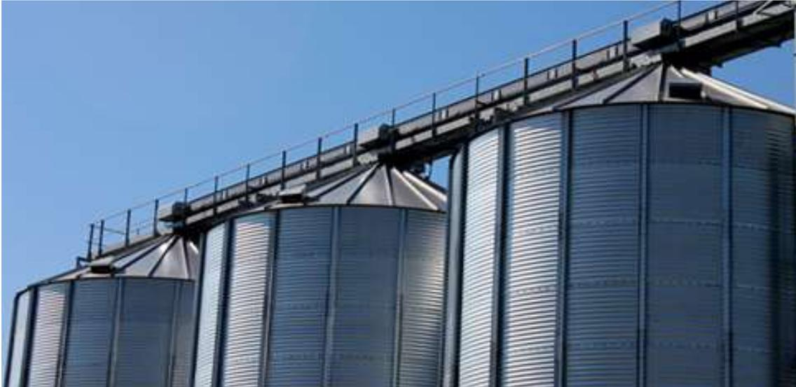
Figura 6.38. Transportador horizontal de grãos
