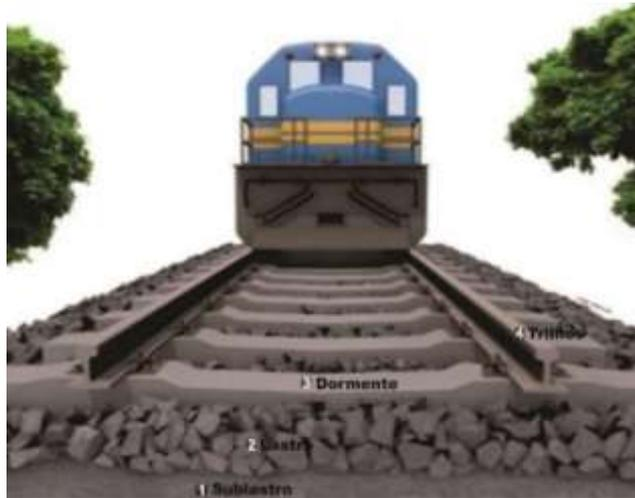
1. **Sublastro** - É uma camada granular (areias naturais, pó de pedra, escórias de fornos siderúrgicos) com espessuras variadas.
