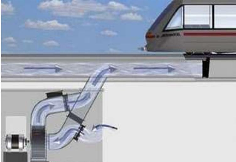
Figura 3.65. Princípio de funcionamento do Aeromóvel
