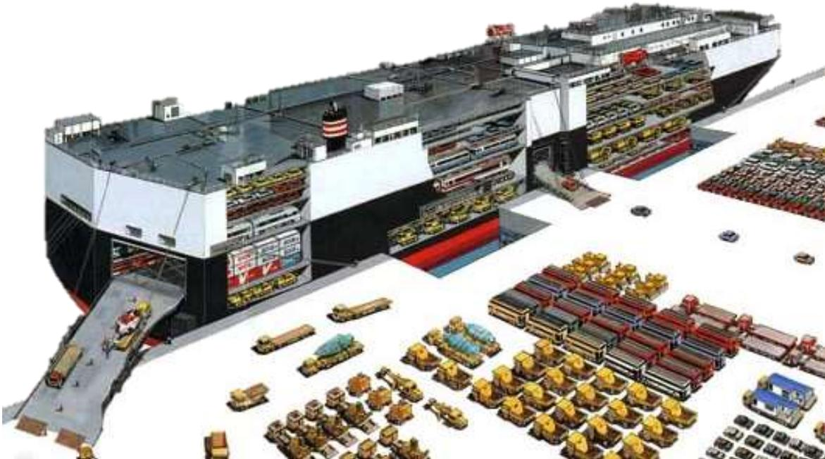
Figura 6.44. Esquema de um navio Roll-on Roll-off com rampa traseira e lateral
