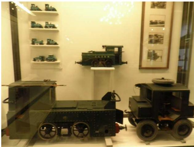
Maquetes de equipamentos elétricos para tracionar as embarcações dentro de túnel-canal, do acervo do Musée de la Batellerie. França.
