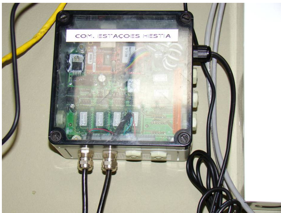
Figura 9 – “Databus” de conexão entre estação Hestia e Computador principal.
