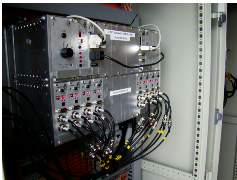
Figura 11 – Estação Hestia dos sensores BL polímero.
