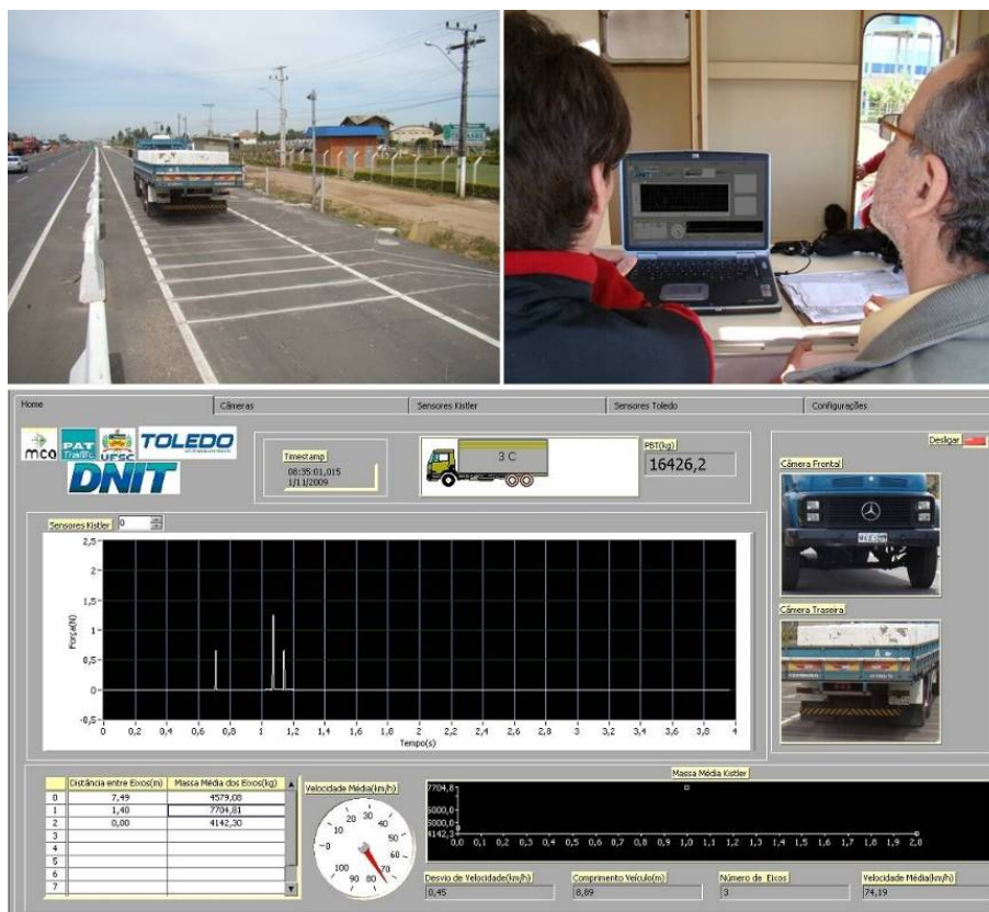
Figura 4 – Aquisição de sinais do sistema piezo-quartzo.
