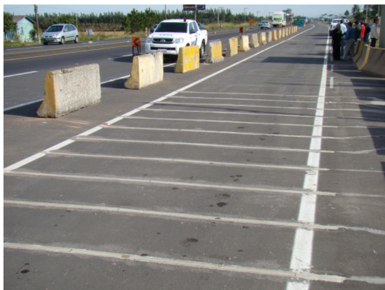
Figura 2 – Sensores de quartzo, cerâmico e polímero
