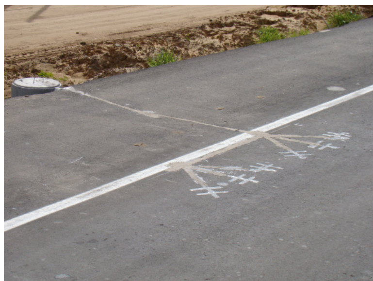
Figura 3 – Sensores “strain gauge” Medição de deflexão
