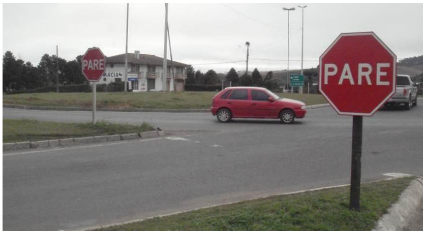
Figura 12 Sinalização vertical (R-1) aproximação da BR-282 – não preferencial
