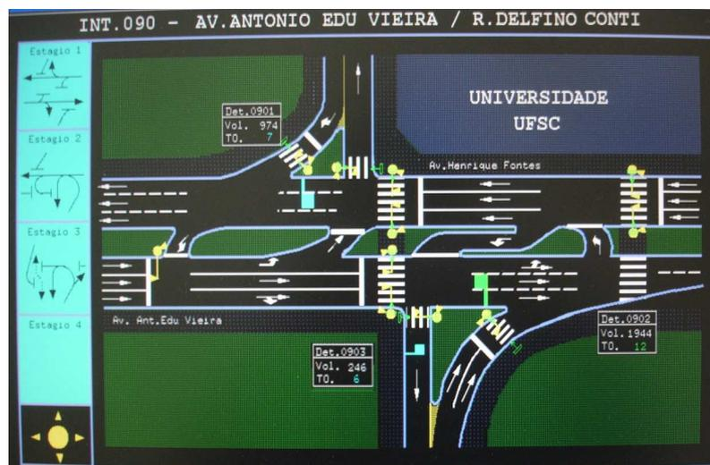
Figura 10 - Esquema do software utilizado com a indicação dos detectores e estágio de manobra
