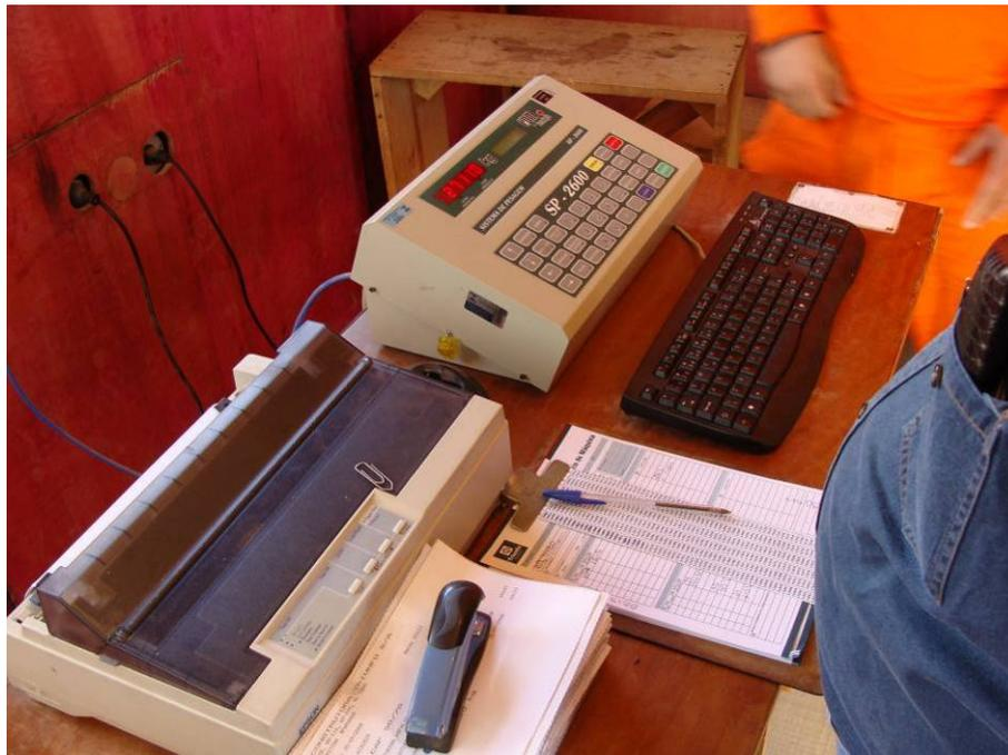
Figura 168 – Leitor da balança e impressora.
