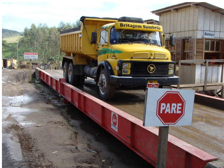
Figura 167 – Estrutura da balança para PBT.
