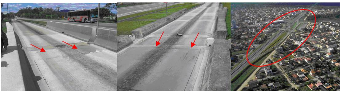
Figura 6 – Balanças MS e LS-WIM instaladas; vista aérea de um posto
