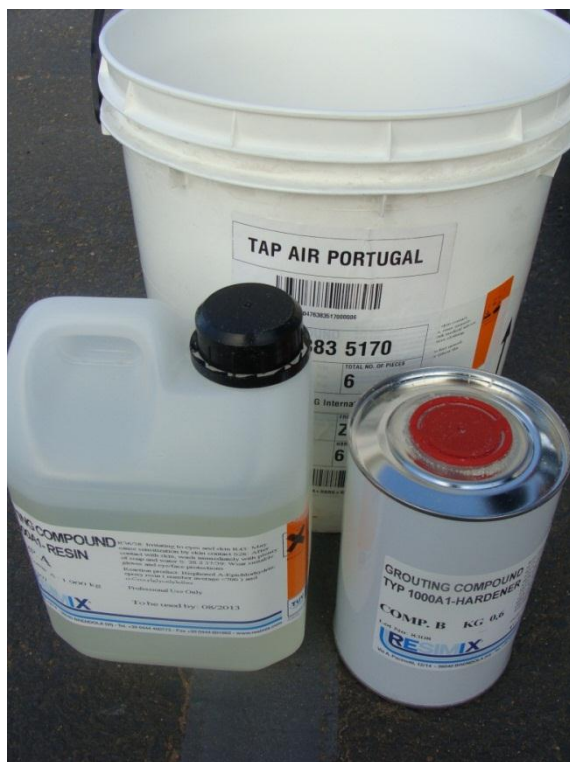
Figura 61 - Resina, endurecedor e finos.
