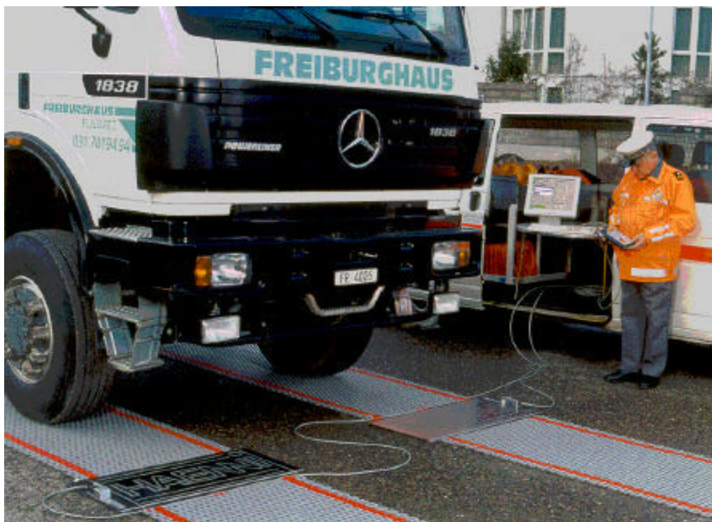
Figura 10 – Sensor tapete capacitivo com equipamento de análise de dados
