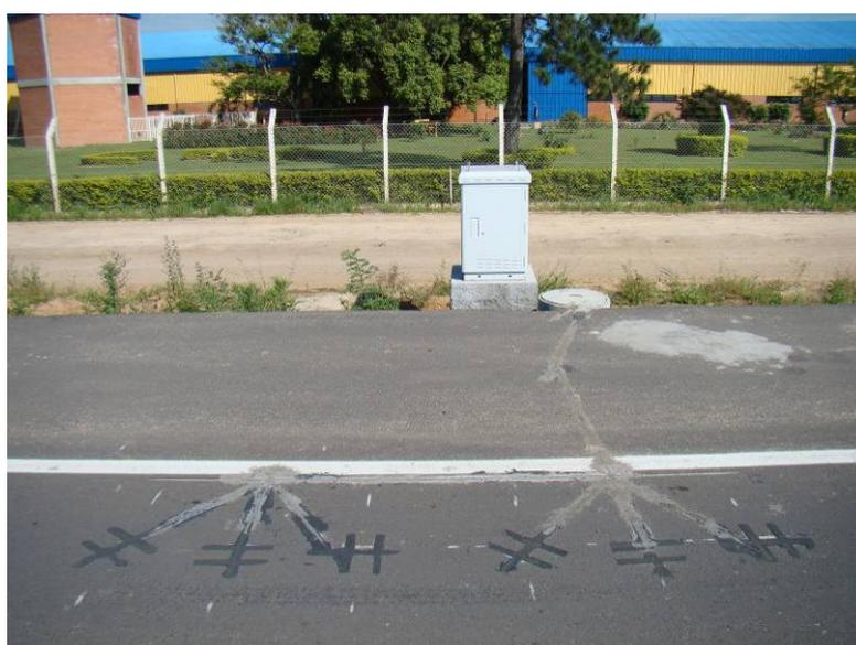
Figura 3 – Sensores “strain gauge” medição de deflexão
