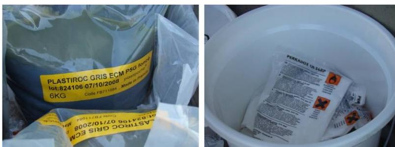
Figura 46 – Resina preparada para aplicação no envolvimento do sensor.
