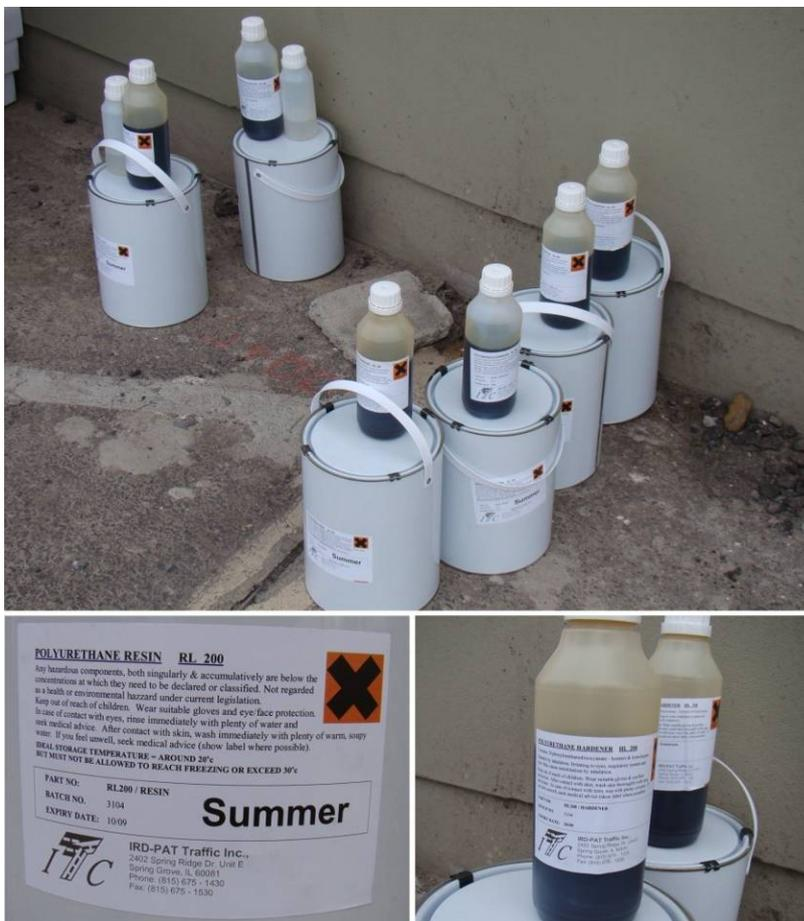
Figura 69 – Componentes da resina para encapsular sensor.
