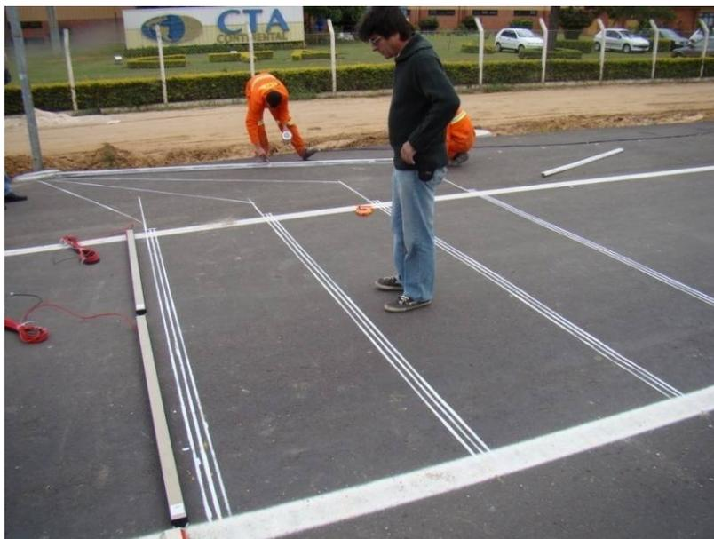
Figura 12 – marcação dos espaçamentos entre as linhas de sensores.
