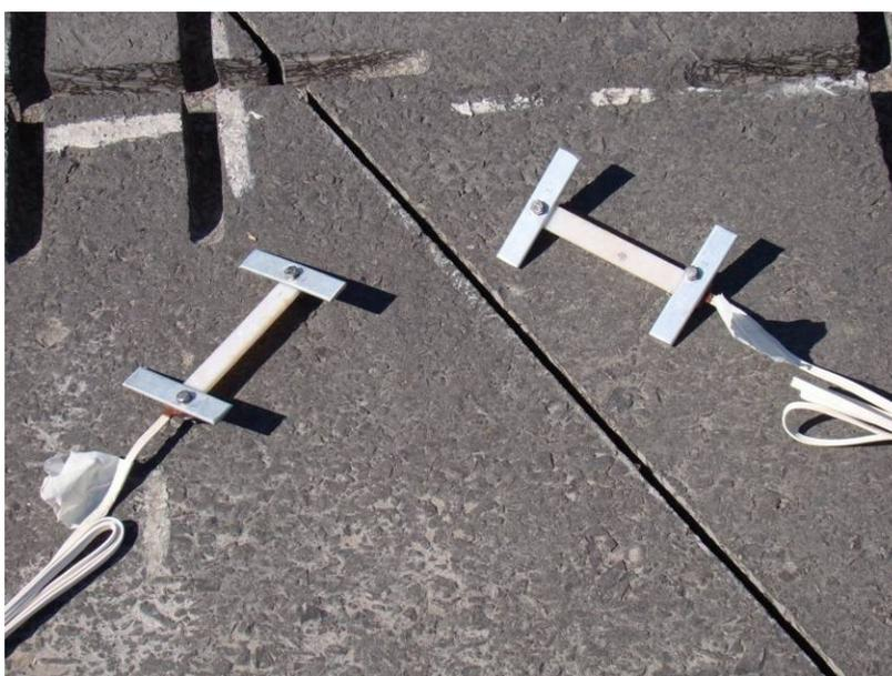
Figura 76 – Montagem dos Sensores de Deformação (Strains Gauge, perfil H).
