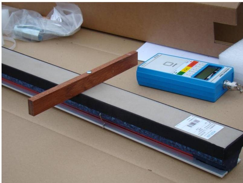
Figura 20 – Sensor, espaçador, grampo e dispositivo de teste de sinal.
