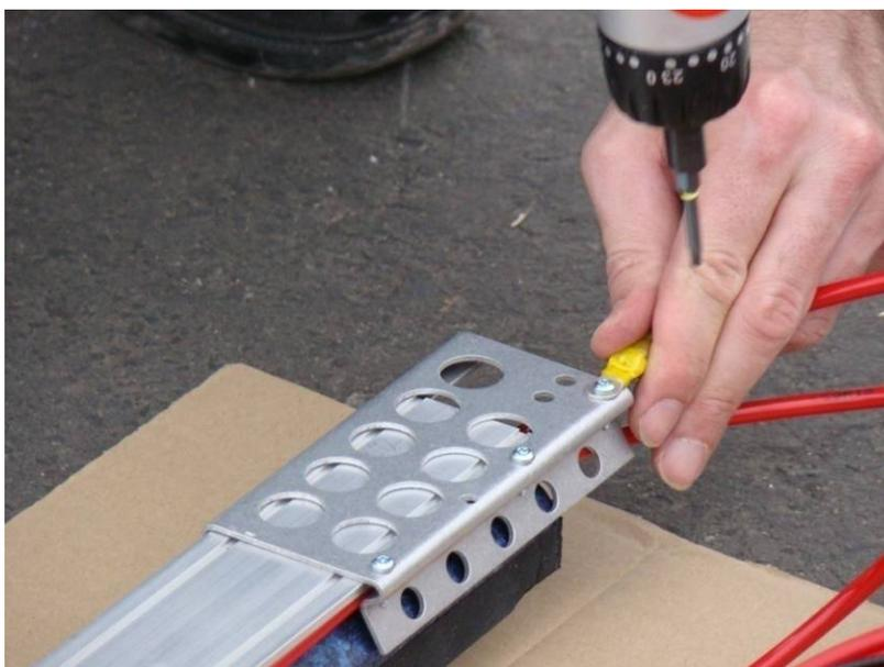
Figura 19 – Placa da extremidade do sensor, fixa os cabos de conexão e o fio terra.
