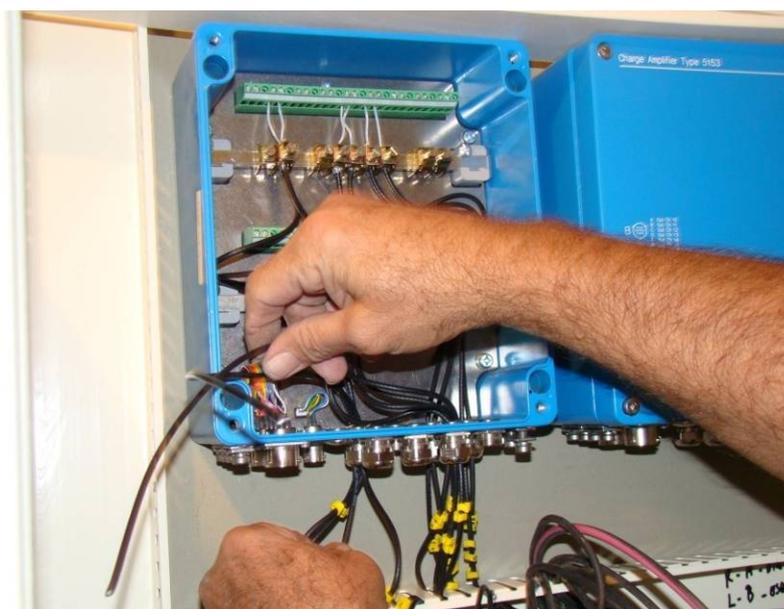
Figura 31 – Amplificador de carga Kistler e cabos de sensores.
