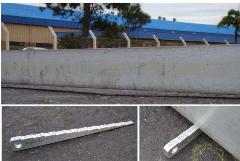
Figura 9 – Verificação das deformações permanentes (na trilha de roda).
