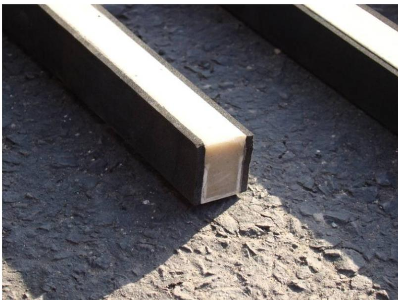
Figura 43 – Detalhe da seção da barra do sensor ECM (cerâmico).
