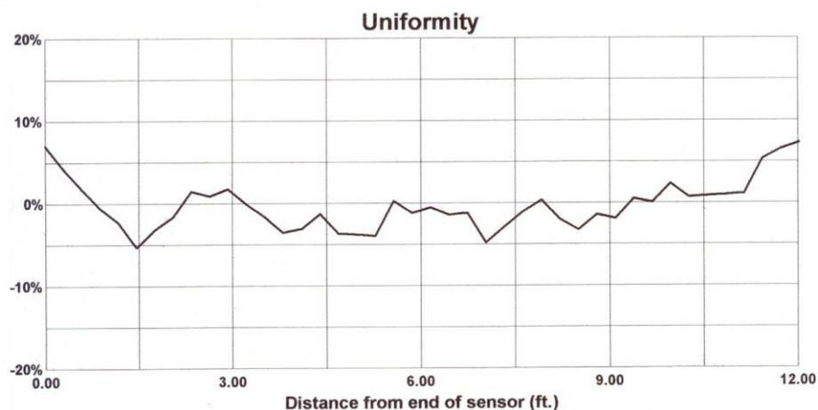
Figura C.12. Dados de Calibração do Sensor BL Traffic Sensor – linha 12
