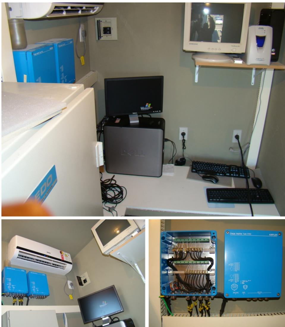
Figura 7 – Equipamentos de aquisição dos sinais dos sensores linhas quartzo.
