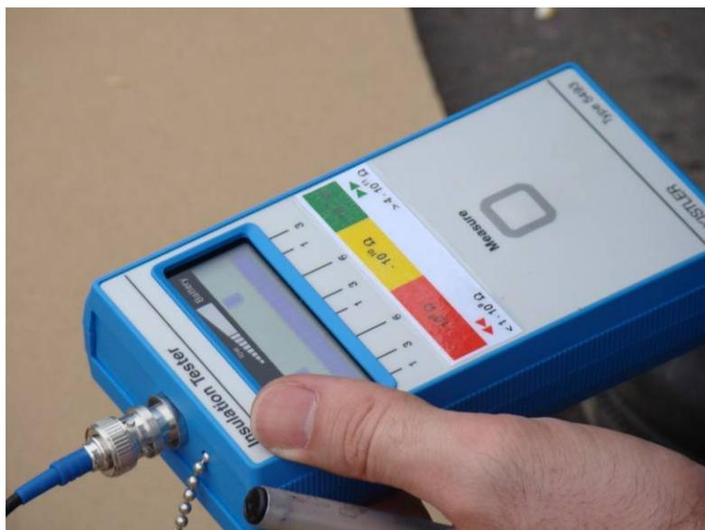
Figura 21 – Dispositivo de teste de sensores (mede resistência elétrica,  $\Omega$ ).
