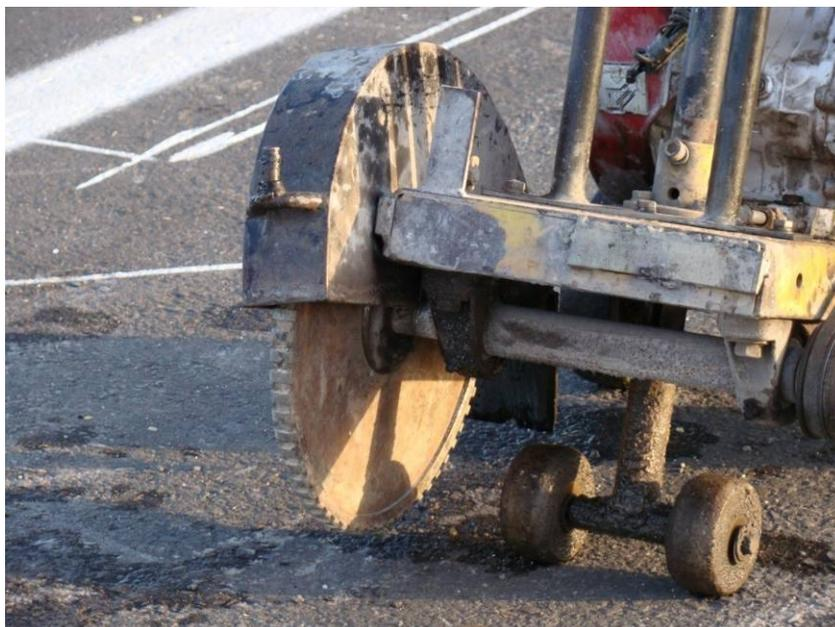
Figura 59 – Serra Circular de espessura 20 mm e ponta diamantada.
