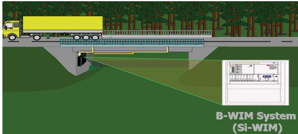
Figura 7 – Sistema SiWIM, instalação esquemática
