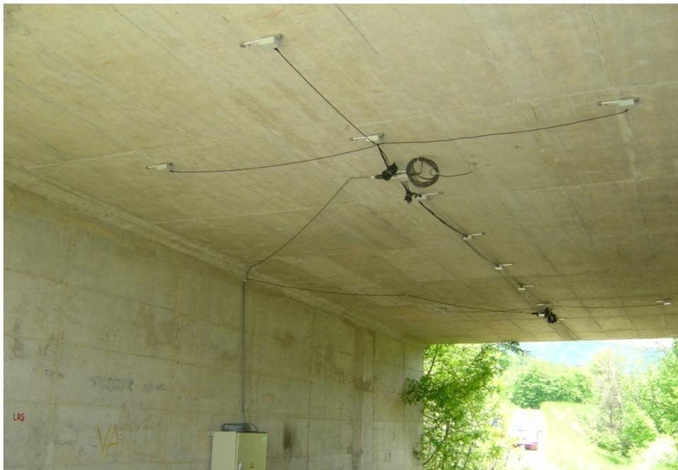
Figura 10 – Sensores SiWIM instalados sob a ponte
