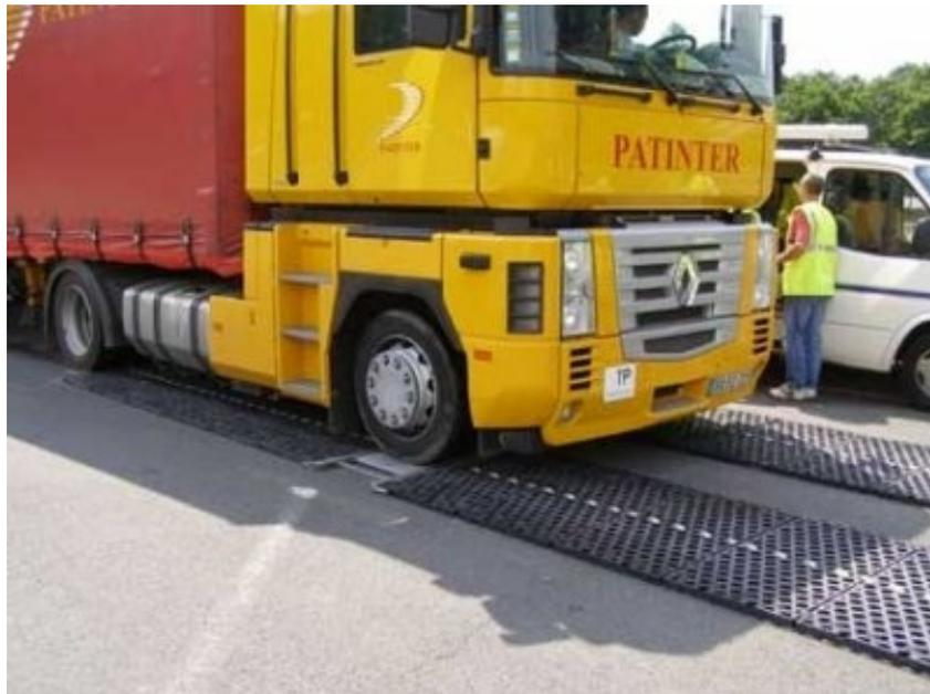
Figura 53 – Pesagem estática, equipamento móvel
