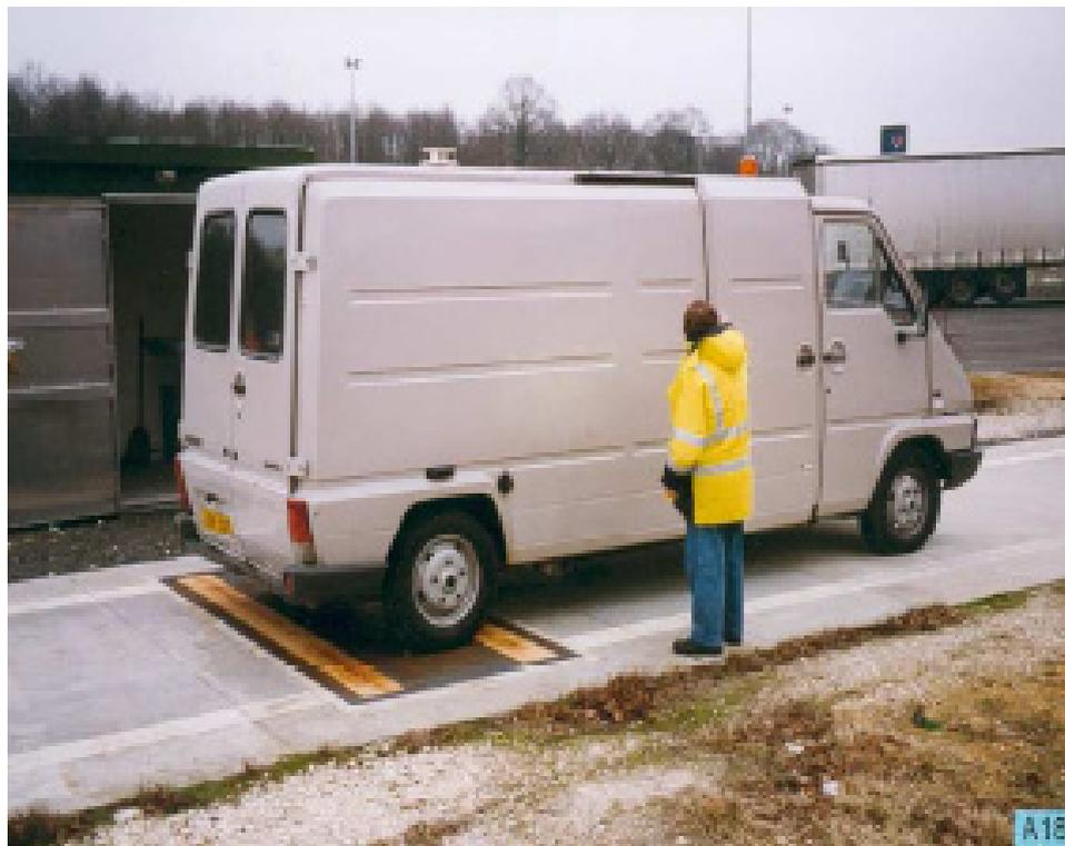
Figura 56 – Pesagem estática, equipamento fixo
