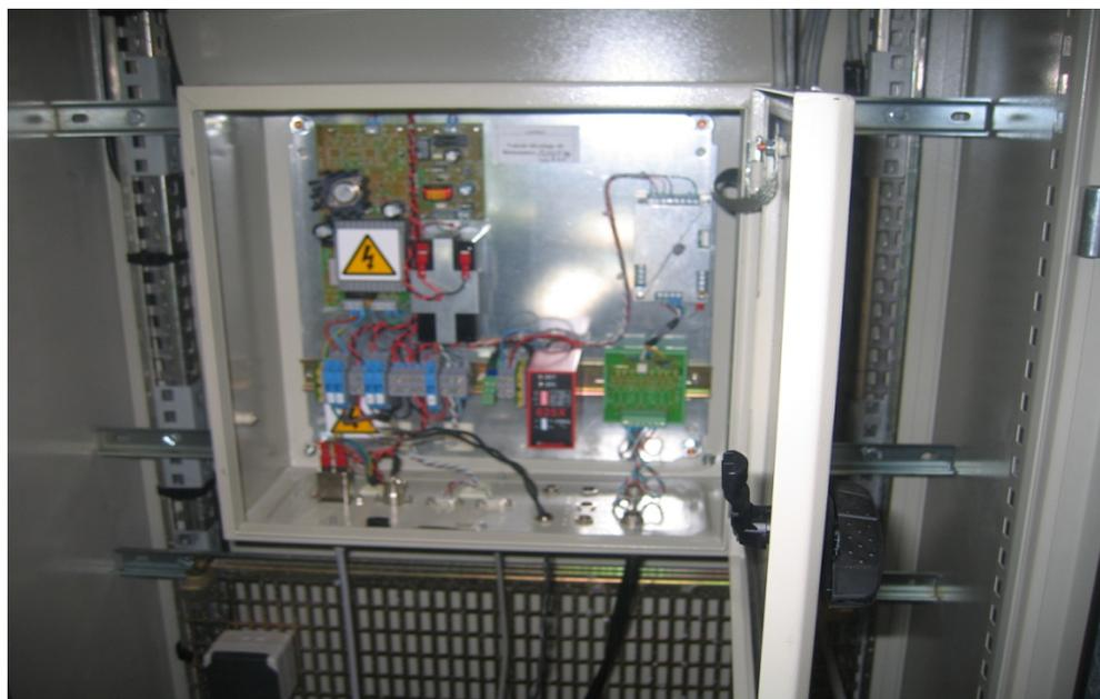
Figura 62 – Eletrônica de aquisição de dados dos sensores da pista
