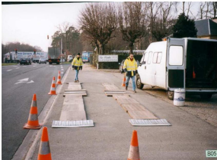
Figura 54 – Pesagem estática, equipamento móvel
