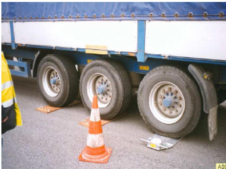
Figura 55 – Pesagem estática, equipamento móvel
